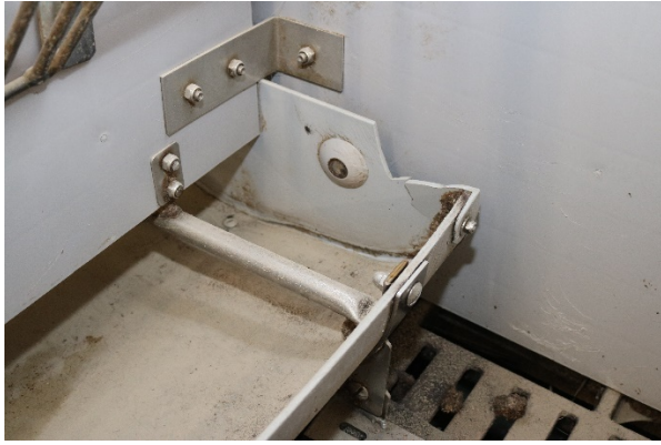
Figur 12. Ekstruderet plastkrybbe med knækket endegavl
